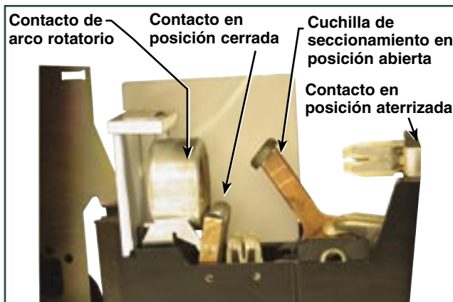
Interruptor de falla suministrada en el Modelo Manual del Vista de 15 kV, 12.5 kA.
