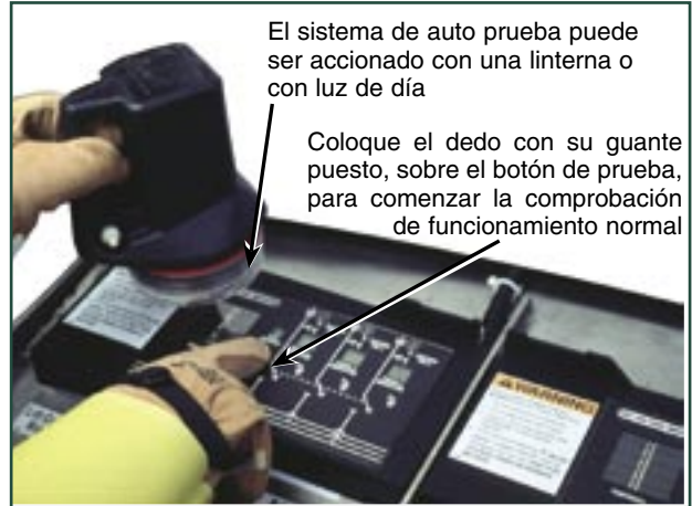
Figura 5. Probando el indicador de voltaje.
